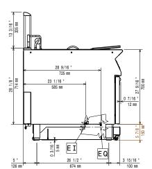
Electrical inlet (power) EQ Equipotential screw
